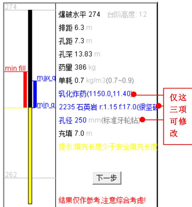
本智能化、图形化工具可以帮助露天矿山爆破设计人员根据不同细分情况设计出更合理的孔网参数！具体地讲就是根据设计的台阶高度及选择的炸药、岩石、孔径，自动计算出孔距、排距、孔深、药量、单耗；然后，就可以根据（参考）这些计算好的参数进行炮孔布孔设计。
